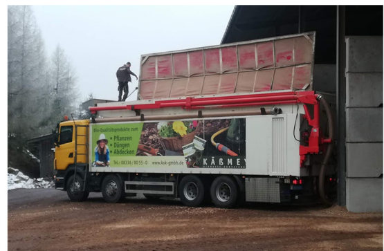
Nákladní automobil s fukarem na substrát
