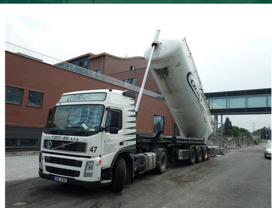
Foukací cisterna pro dopravu a instalaci substrátů na střechy
